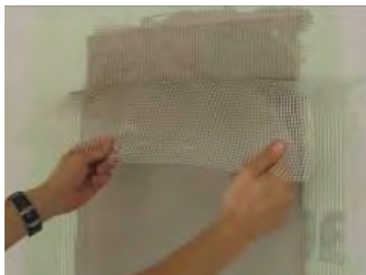
Obr. 4 – Odtržení sklotextilní síťoviny
