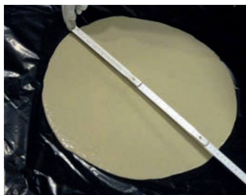
Měření průměru rozlitého potěru
