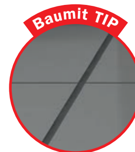
Dilatace provádějte v rastru max. 3x3 m, v max. poměru stran 1:2
