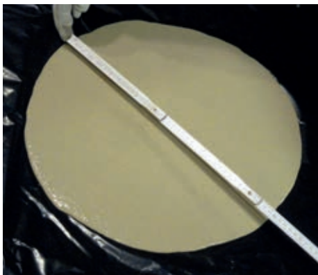
Ověření správné konzistence lité směsi rozlivovou zkouškou.
