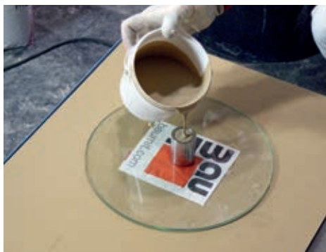
Ověření správné konzistence lité směsi rozlívovou zkouškou.
