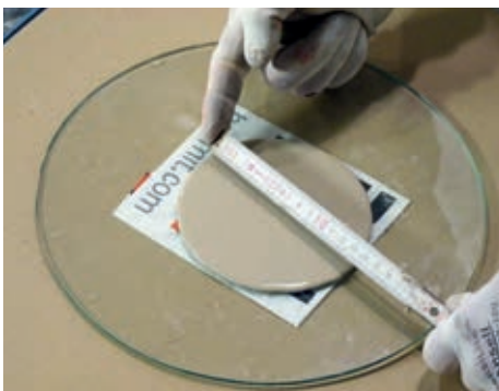
Použití předepsané rozlívové nádoby, hodnota výsledného rozlívu musí být 130 \pm 5 mm.
