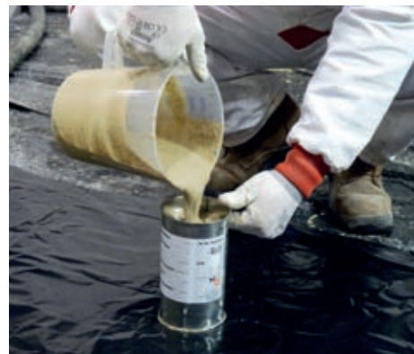
Použití předepsané rozlivové nádoby, hodnota výsledného rozlivu musí být v rozmezí 42–45 cm.
