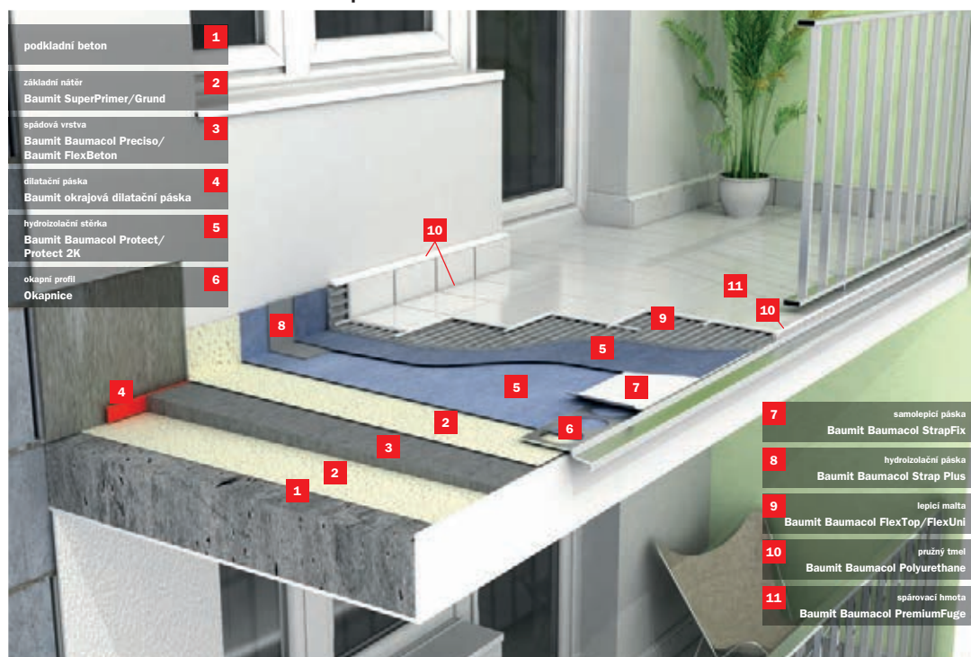
Obrázek 8: Certifikované řešení nezateplené balkonové konstrukce
