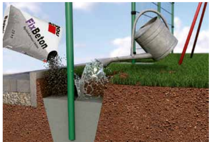
Baumit FixBeton – 2. způsob aplikace – zalití suché směsi
