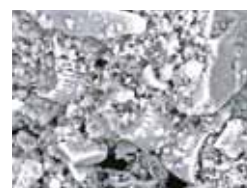
Mikroskopicky přiblížený snímek povrchu s omítkou Baumit StarTop ukazuje, jak se na něm šíří voda a jak díky tomu rychle schne
