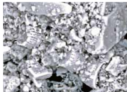
Mikroskopicky přiblížený snímek povrchu s omítkou Baumit StarTop ukazuje, jak se na něm šíří voda a jak díky tomu rychle schne
