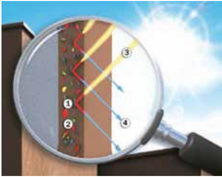
Povrch s cool pigmenty: 1 - Cool pigment, 2 - Standardní pigment, 3 - Sluneční záření (světelné spektrum), 4 - Odražené světlo.
