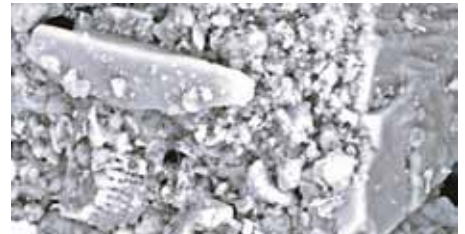
Mikroskopicky přiblížený snímek povrchu s omítkou Baumit StarTop ukazuje, jak se na něm šíří voda a jak díky tomu rychle schne
