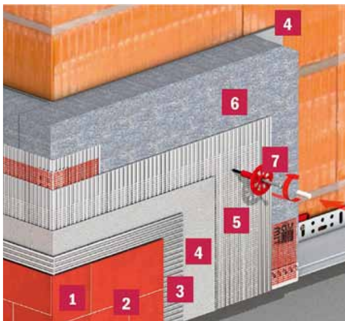
Baumit Ceramic – řez fasádou – vrstvy: 1 – keramický obklad, 2 – Baumit Ceramic F – cementová spárovací hmota, 3 – Baumit Baumacol FlexTop – flexibilní lepidlo na obklady a dlažby, 4 – Baumit StarContact – lepicí a stěrková hmota s vysokou přidržitostí, 5 – Baumit KeraTex – sklotextilní síťovina pro výztužnou vrstvu, 6 – Baumit StarTherm – šedé objemově stabilizované fasádní desky z polystyrenu, 7 – Baumit S – hmoždinky s ocelovým šroubovacím trnem
