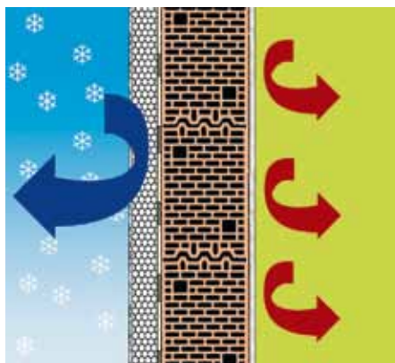
Baunit open je navržen tak, aby zdivo mohlo volně „dýchat“ a v konstrukci nedocházelo ke kondenzaci vodní páry. Tím se vytváří zdravé vnitřní prostředí v zimním i letním období.
